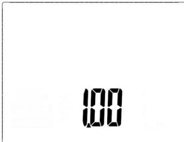
En la pantalla del dispositivo, primero se muestran todos los segmentos (autotest) y, a continuación, aparece brevemente la pantalla con la versión de software.
