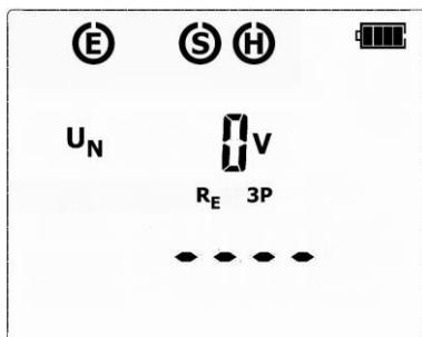
El medidor pasa a la pantalla de función de medición  $R_{E3P}$ . El medidor está en modo de medición de tensión de interferencia entre los terminales de medición. La tensión de medición es compatible con la tensión seleccionada al configurar el dispositivo.
