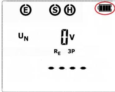
El nivel de carga de las baterías y pilas está continuamente indicado por el símbolo de pila en la esquina superior derecha de la pantalla.
