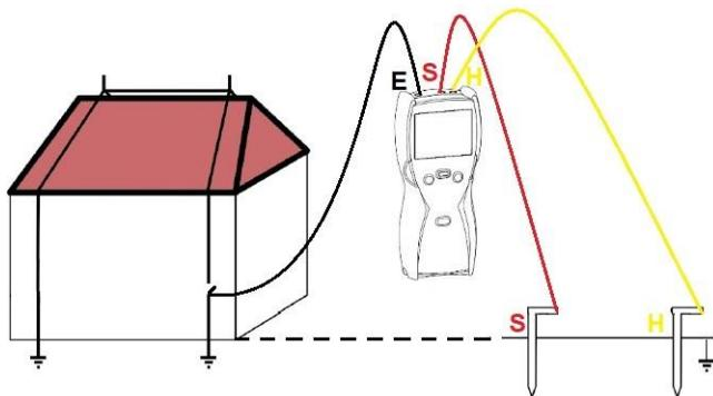
Los cables de medición deben estar conectados a las tomas de medición en el dispositivo como se muestra en la figura de arriba.
