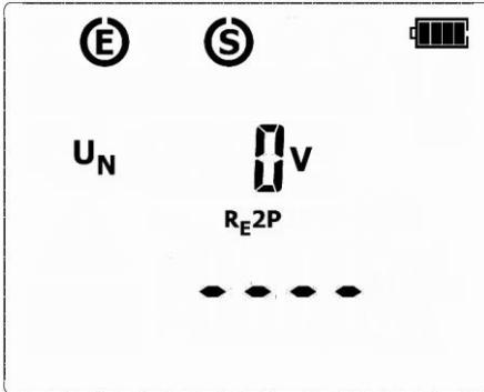
En las funciones de medición, antes de pulsar el botón **START** el medidor controla la tensión en los terminales de medición (entre la toma **E** y las tomas **S** y **H**), y el valor de la tensión de interferencia se visualiza en la pantalla.
