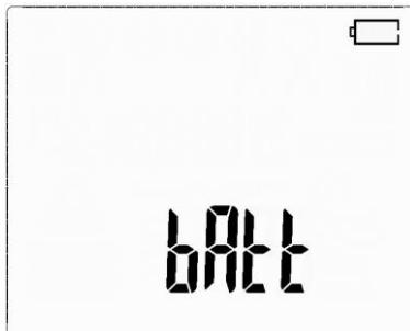
El mensaje **bAtt** significa que las baterías están extremadamente agotadas, todas las mediciones se bloquean. El medidor se apaga automáticamente después de unos 5 segundos.
