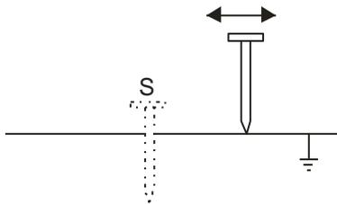
Repetir las mediciones (puntos 4, 5, 6) moviendo el electrodo de tensión unos metros: alejándolo y acercándolo a la toma a tierra examinada.
