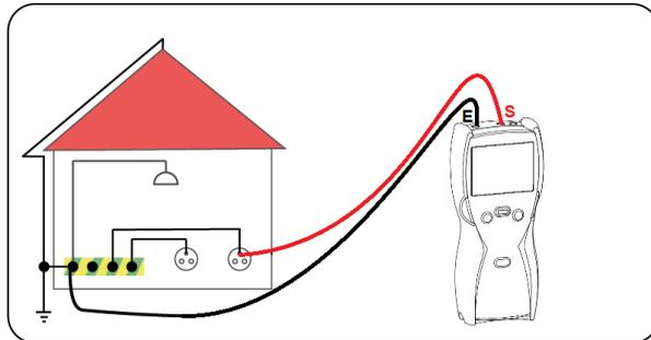
Los cables de medición deben estar conectados a las tomas de medición en el dispositivo como se muestra en la figura de arriba.
