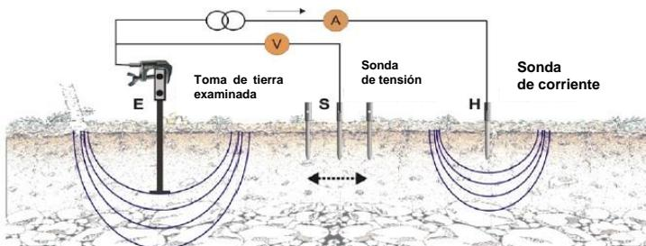
Arriba se presenta el método de medición de la resistencia de tierra con el método de 3 polos. En la figura se mide la resistencia de tierra  $R_E$ . Para medir se deben colocar dos electrodos auxiliares:
