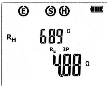
Después de terminar la medición, se muestran los resultados de todas las mediciones que se han realizado: en la parte inferior de la pantalla, el resultado principal **R<sub>E</sub>**, y en la parte superior de la pantalla, los resultados adicionales del valor **R<sub>H</sub>**. **El resultado se muestra durante 20 segundos.** Se lo puede visualizar de nuevo pulsando **ARRIBA**.
