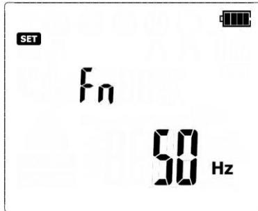
Después de encender el medidor aparece la pantalla de configuración de la frecuencia de la red en la que opera **Fn**.
